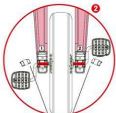
3 Finalize colocando a capa plástica observando a numeração 1 e 2 cada qual para seu lado e aperte os 4 parafusos com auxílio da chave philips.
