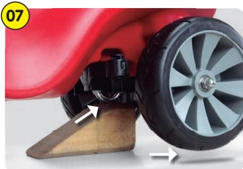
Coloque um calço embaixo da haste da direção longa para que a mesma não desça enquanto é montada. As rodas devem ficar suspensas, acima do chão.
