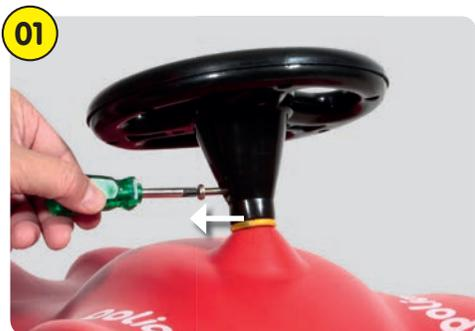
Retire o parafuso da direção com o auxílio de uma chave philips.
