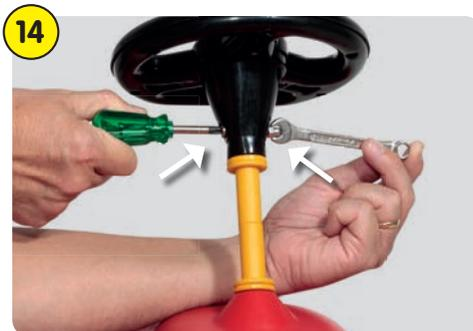
Insira o parafuso da direção e parafuse o volante na haste, com o auxílio de uma chave philips e uma chave de boca nº 8 (8 mm) para segurar a porca calota.
