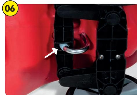
Certifique-se de que a ponta da haste da direção longa encaixe no meio da barra de direção.
